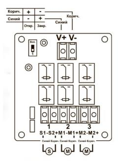
S: Запирающий привод М: Цепной привод
