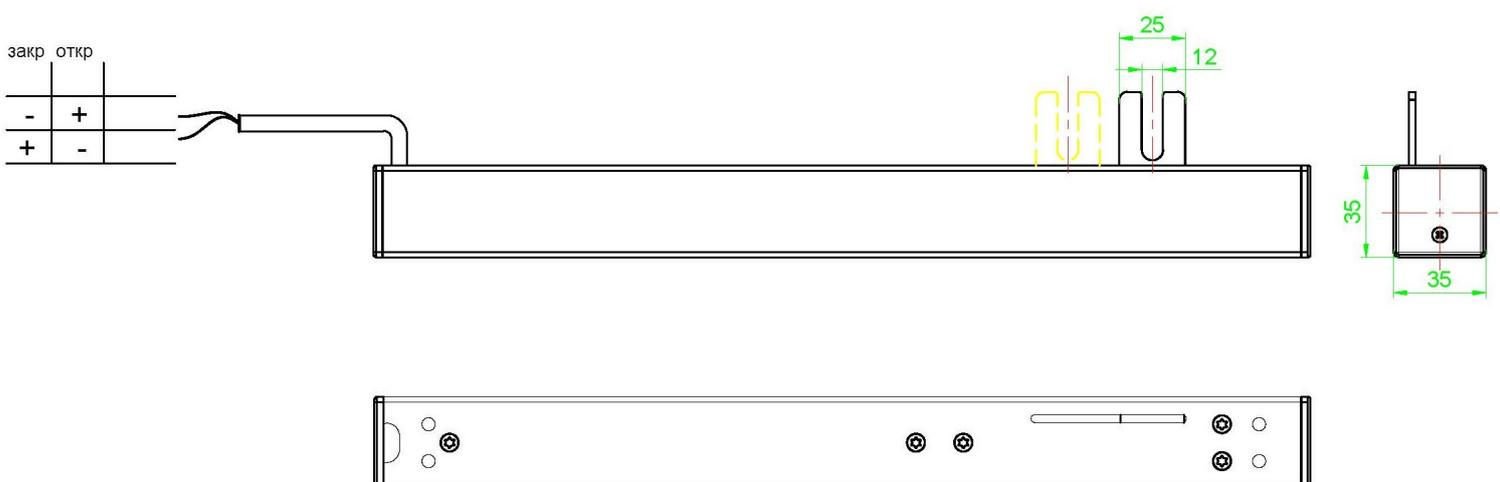
**Электрическое подключение привода :**
