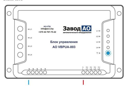
После первого включения Блок управления AO VBPUA-002 перейдёт в режим быстрого сопряжения. Светодиодный индикатор WI-FI начнёт мигать в режиме «два раза коротко, один раз длинно».
